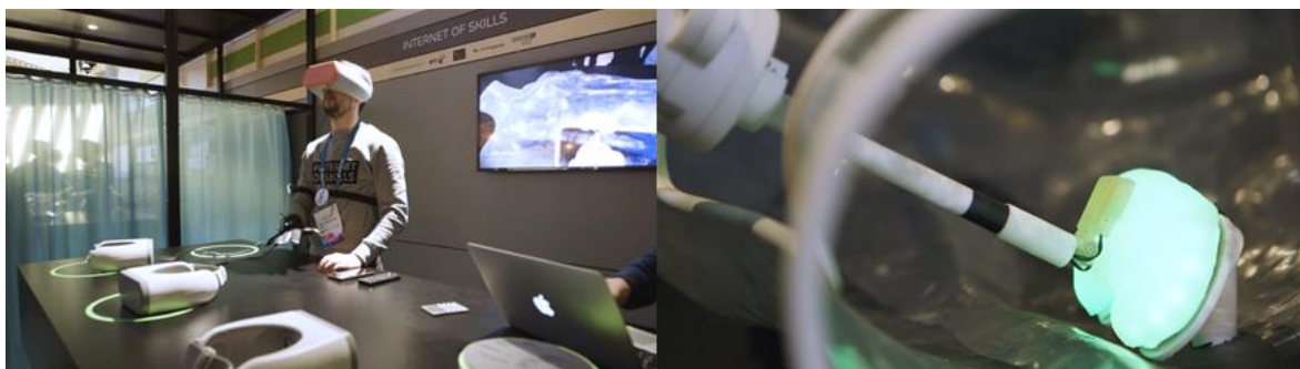
Figura 7. Demostración realizada por Ericsson en el MWC 2017. En la imagen de la izquierda se ve a un usuario equipado con un guante háptico y casco de realidad virtual. En la de la derecha, se ve un brazo robótico que controla al usuario a distancia. El brazo está equipado con sensores hápticos en su extremo, para poder transmitir al usuario el sentido del tacto del objeto con el que interactúa.
